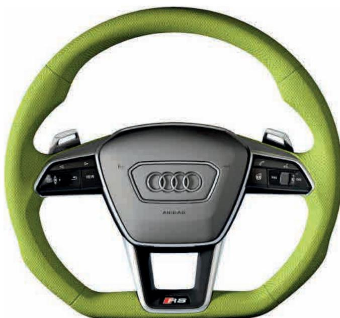
Équipement de base de la RS e-tron GT avec jante du volant intégralement perforée, grandes palettes, chauffage du volant et logo RS
