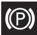
Si la touche E538 est actionnée à une vitesse du véhicule inférieure à environ 2 km/h, le frein de stationnement est activé par le calculateur d'ABS J104. Le frein de stationnement immobilise le véhicule en bloquant les roues de l'essieu arrière.
